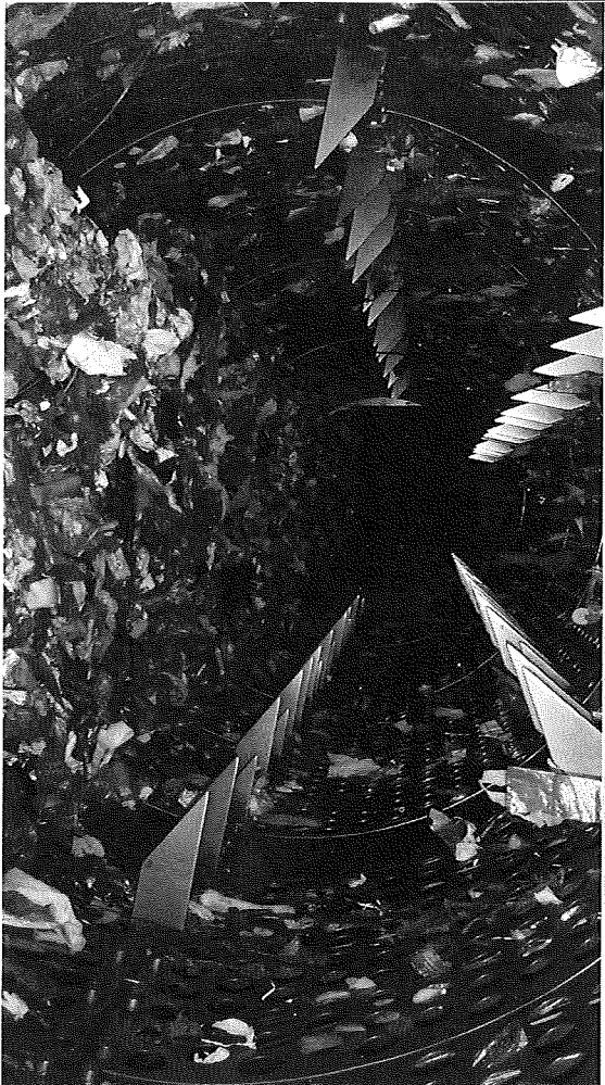
Siebtrommel: Dank der Gewichtsreduktion halbieren sich die Verbrennungskosten, welche sich nach Abfall pro Tonne bemessen.
